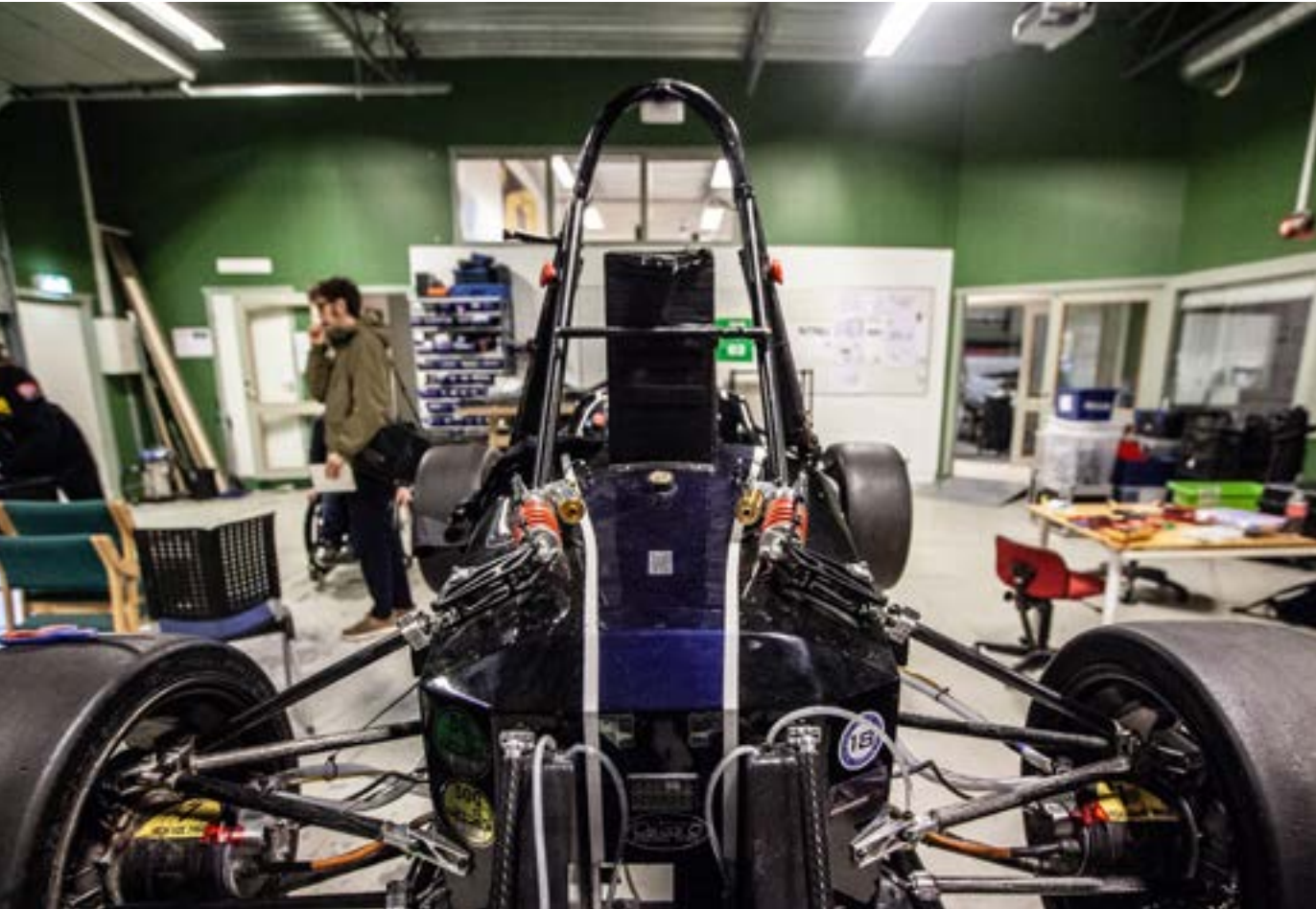
LETTVEKTER: Bilens materiale består av karbon med aluminium honey-comb i kjernen. Dette gjør bilen ekstremt lett, noe som gir fordeler på flere plan.
