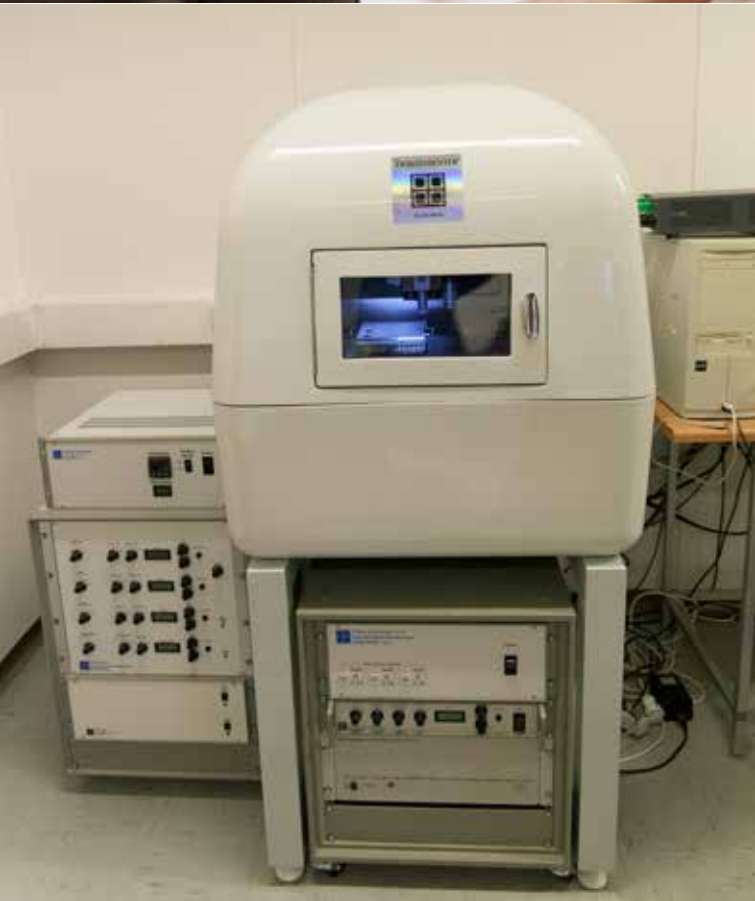
NØYAKTIG PRODUKSJON: Jianying He gjer mykje av arbeidet ved Nanomekanisk lab. Laben står på fire store pillarar, slik at ingen vibrasjonar som kan forstyrre dei sensitive instrumenta finn vegen til desse.
