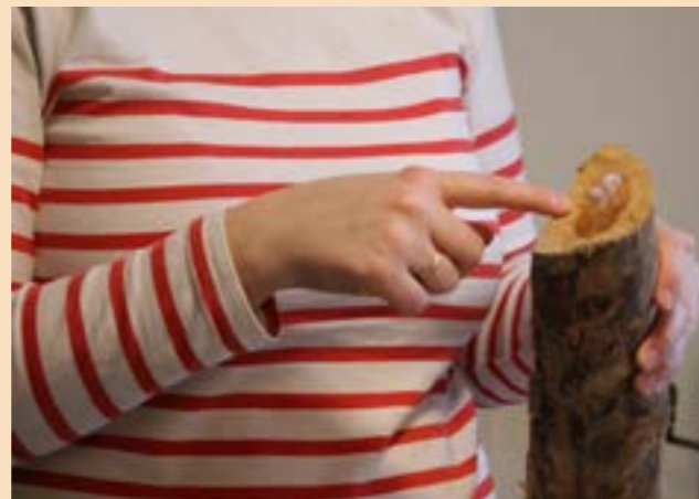
VEDTESTEN: For å sjekke om veden er bra nok, kan ein bruke Zalo til å blåse boblar gjennom vedkubba. Foto: Ayne Kifle Assefa Aalen
