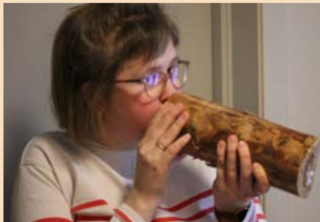
VEDTESTEN: For å sjekke om veden er bra nok, kan ein bruke Zalo til å blåse boblar gjennom vedkubba. Foto: Ayne Kifle Assefa Aalen
